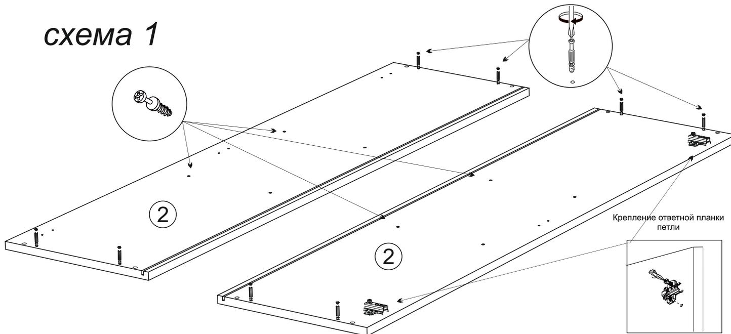
3. Соберите корпус тумбы. Для этого соедините эксцентриковыми стяжками и шкантами боковины №2 и вязки №3, а вязки №4 установите на стяжки Rafix. Вставьте в пазы заднюю стенку ДВП №1, установите уголки Rv8 на заднюю стенку ДВП №1 при помощи шурупов 4x16, как показано на схеме 2.
