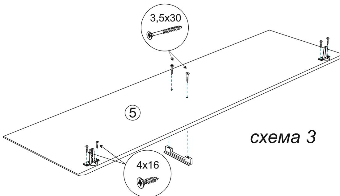
5. Установите навесы на тыльные стороны боковин при помощи шурупов 4x30, Повесьте тумбу на место, прикрутите створку к боковине тумбы, отрегулируйте зазоры, как показано на схеме выше.
